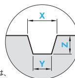
Ⓢ 浅溝付クラウンタイプの外径D寸法は、浅溝部想像線上の寸法になります。
