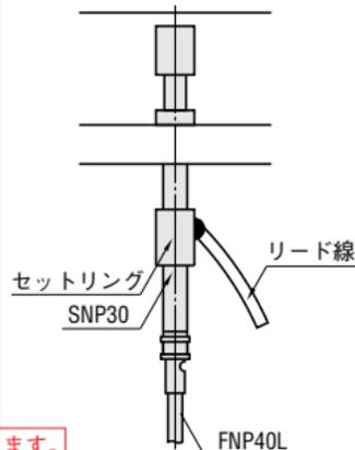
●SNP30 先端形状パターン ④先端形状Sはフルストローク時に横荷重があると、プランジャの段部が引っ掛かり戻らない恐れがあります。
